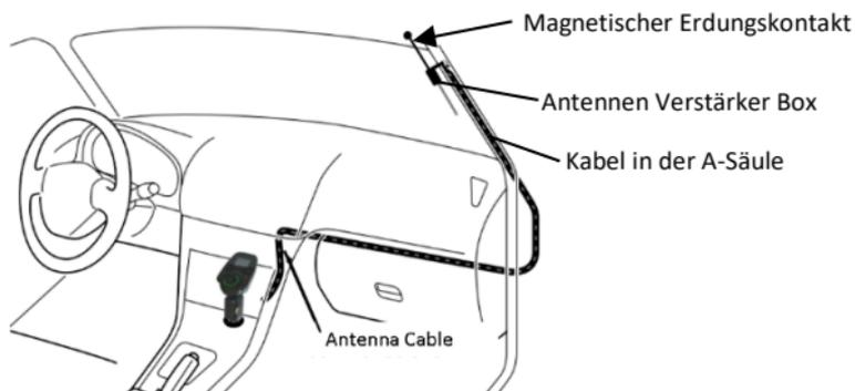
7. Verwenden Sie kleine Stücke von transparentem doppelseitigem Klebeband zum Fixieren des Antennenkabels.
