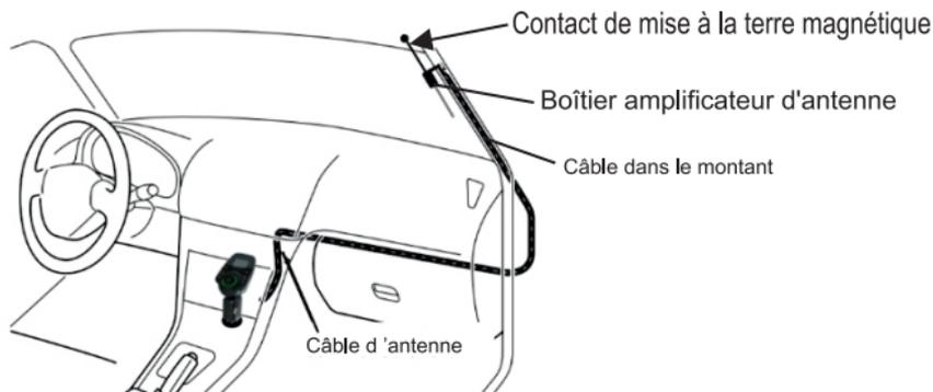
7. Utilisez de petits morceaux de ruban adhésif double-face transparent pour fixer le câble de l'antenne.
